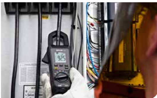
Wechselstrom-Echtheffektivwertmessungen (TRMS) bis 600 A
