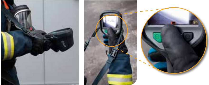
FLIR K-Serie mit "Pistolengriff" und leicht zugänglichen Tasten
