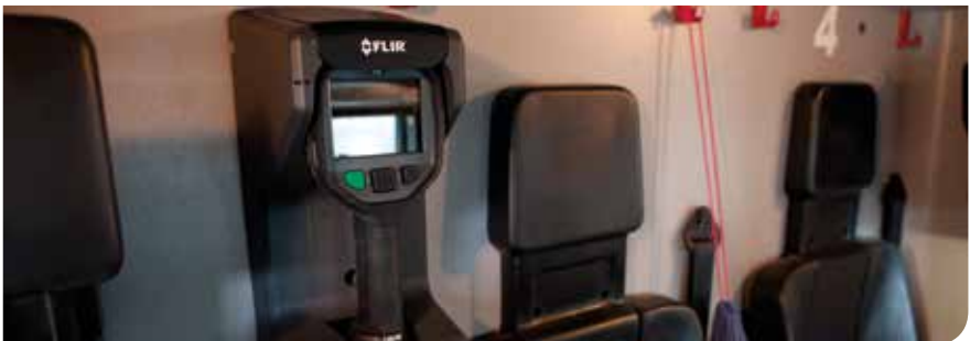
Die FLIR K-Serie ist als Grundausrüstung für jeden Feuerwehrmann nicht mehr wegzudenken. Das als Zubehör erhältliche Kfz-Ladegerät sorgt dafür, dass die Kamera immer einsatzfähig ist.
