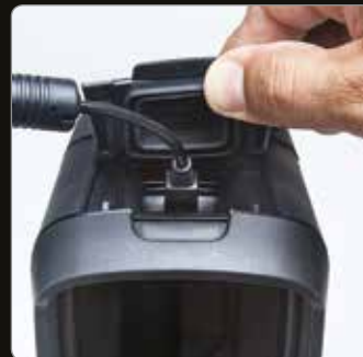
USB-Anschluss zum schnellen Herunterladen von Bildern
