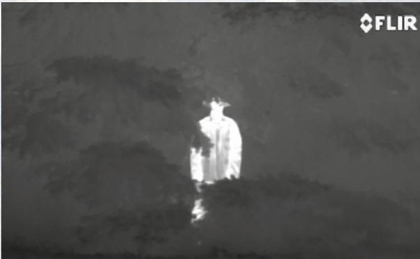
*Wärmebildtechnik: Ein Mensch, der sich hinter Büschen versteckt, wird deutlich sichtbar, da Wärmeunterschiede fast nicht zu vertuschen sind.*
